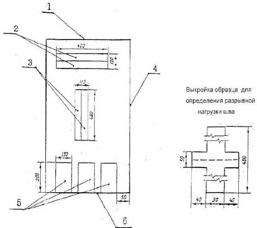
1 – горловина; 2 - образец для определения разрывной нагрузки ткани по утку и числа нитей на 10 см; 3 - образец для определения разрывной нагрузки ткани по основе и числа нитей на 10 см; 4 - бок; 5 - образец для определения разрывной нагрузки донного шва; 6 - дно.
